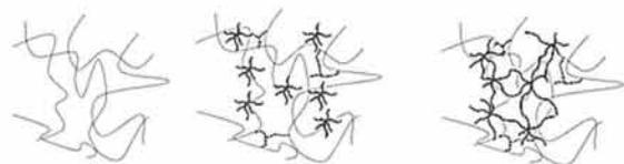
그림 9. UV 경화에 의한 다관능성 모노머의 가교 반응 모식도.<sup>22</sup>
