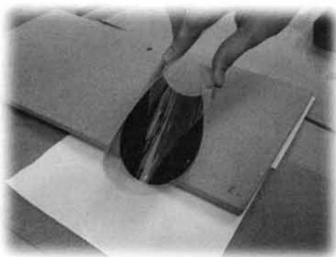
그림 7. PET 필름에 의한 두께 75 μm 실리콘 웨이퍼 휨(warp) 테스트 (서울대 접착과학 및 바이오복합재료 연구실 자료).
