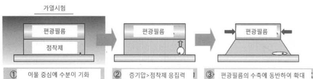
그림 13. 발포의 발생 과정 모식도.
