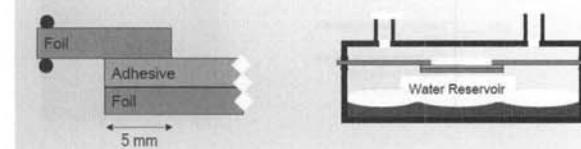
그림 28. 투습/투산소율을 측정할 수 있는 Mocon test의 모식도.
